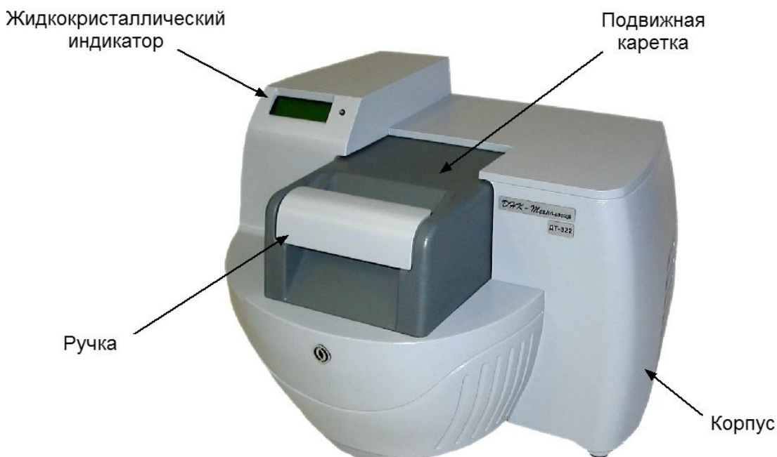
Рис.2. Схема организации прибора
